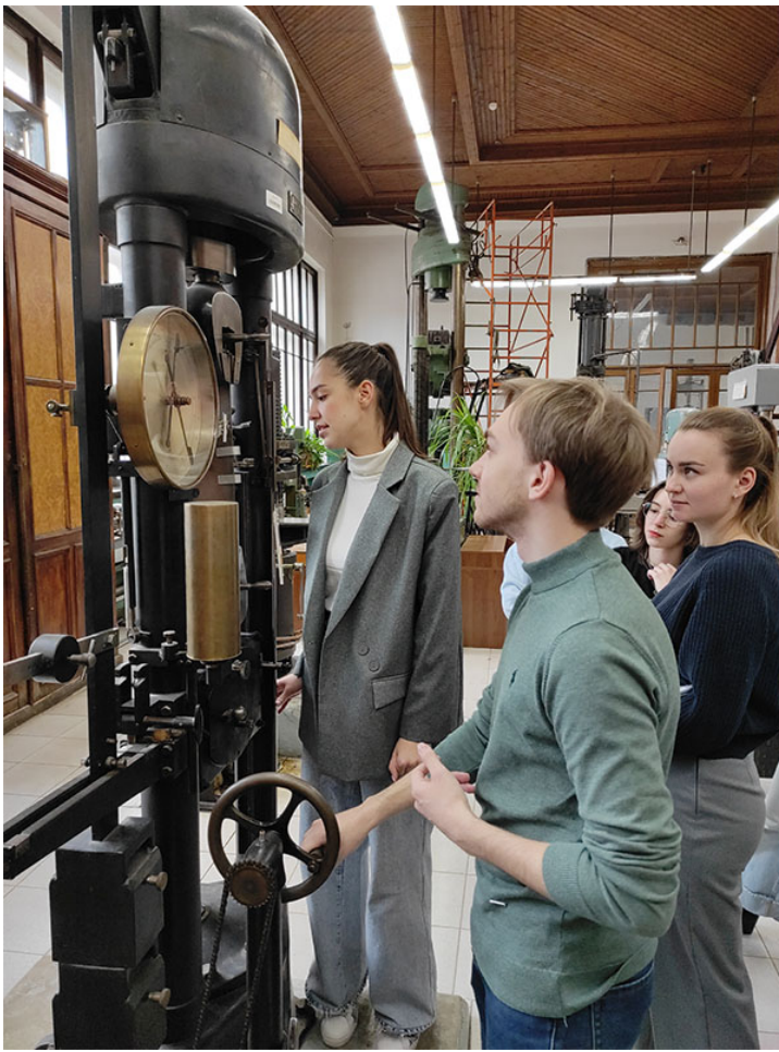
Лаб. работа № 7: «Изучение упругих деформаций при кручении стержня круглого сечения (сталь)».
