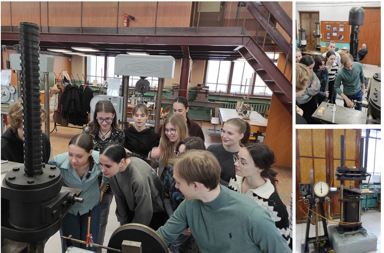
Лаб. работа № 3: «Испытание на сжатие образцов различных материалов (сталь, чугун, дерево вдоль и поперек волокон)» на гидравлическом прессе Амслера.
