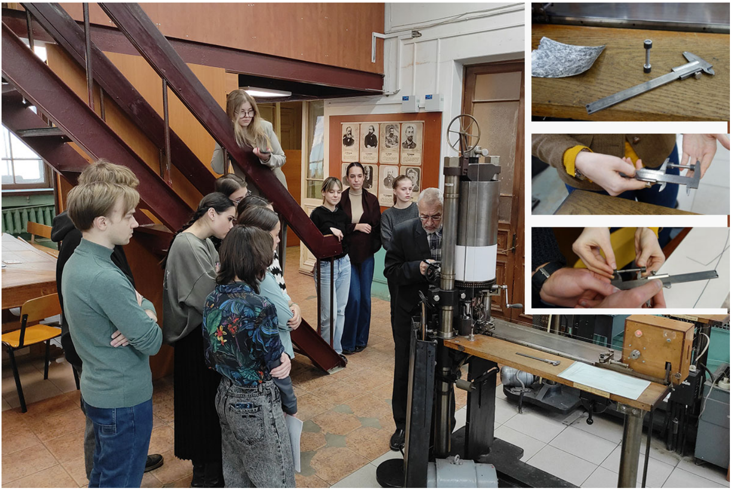
Лаб. работа № 3: «Испытание на сжатие образцов различных материалов (сталь, чугун, дерево вдоль и поперек волокон)» на гидравлическом прессе Амслера.
