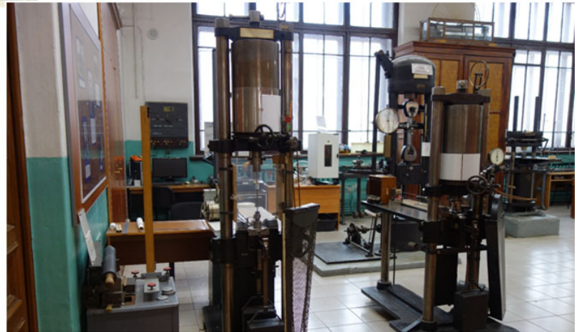
Рис. 6. Универсальный испытательный пресс Гагарина. В кружке — образец в реперсоре.
