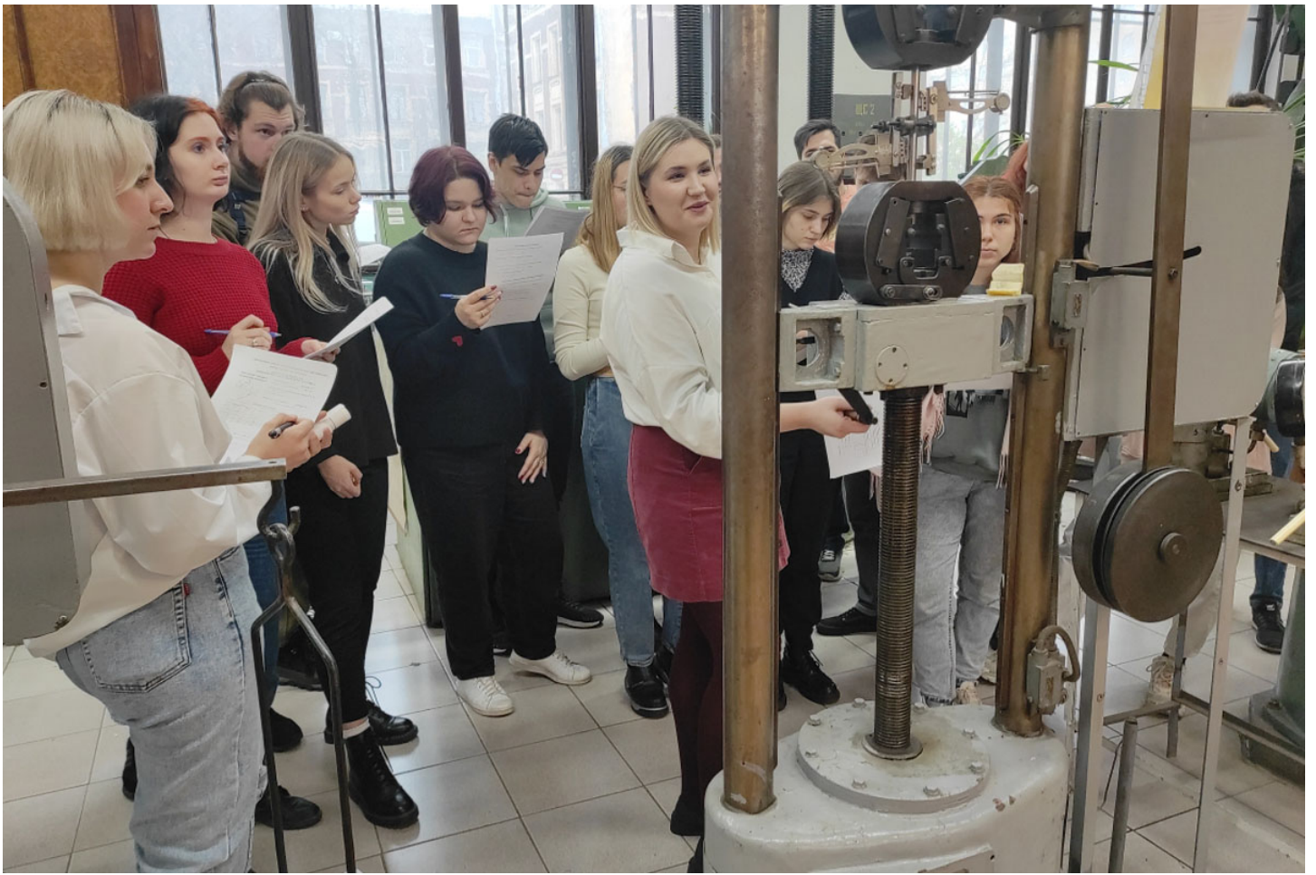
Лаб. работа: «Определение модуля упругости материала (сталь)»
