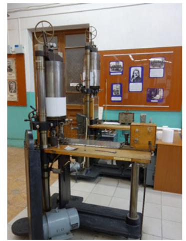
Рис. 6. Универсальный испытательный пресс Гагарина. В кружке — образец в реперсоре.
